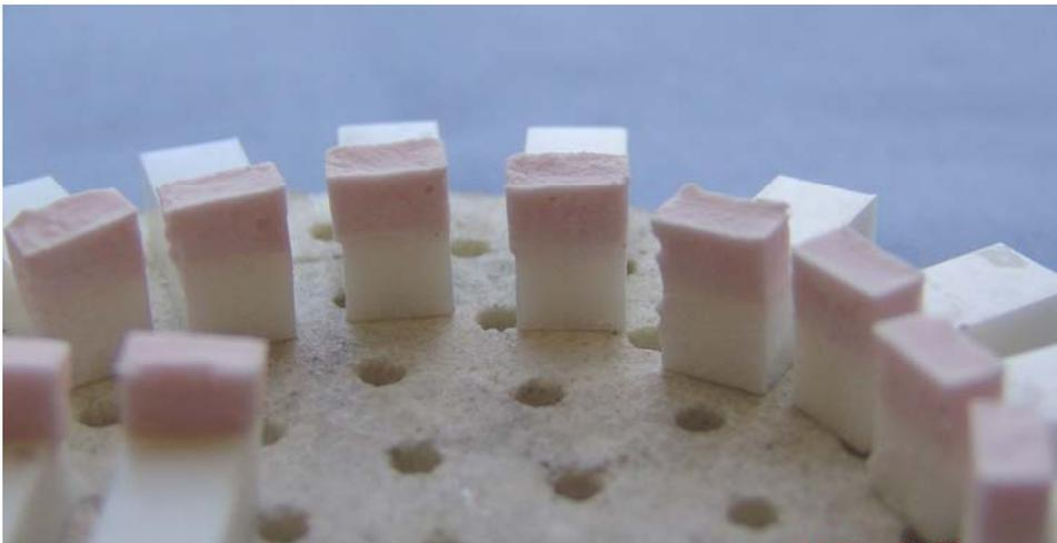
Abb. 24: Prüfkörper vor dem Dentinbrand
