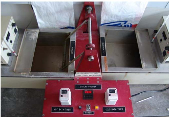
Abb. 18: Das Gerät für Thermolastwechsel
