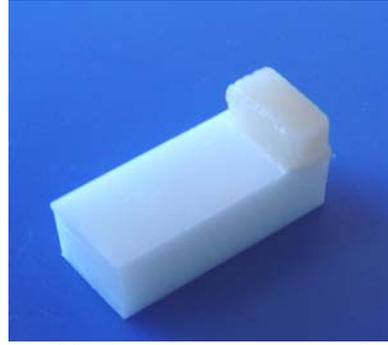
Abb. 23: Prüfkörper nach dem Sintern der Dentinmasse
