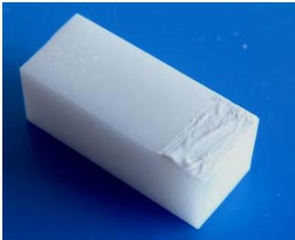
Abb. 21a: Prüfkörper vor Sintern der Grundmasse
