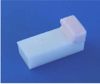
Abb. 22: Prüfkörper vor dem Sintern der Dentinmasse
